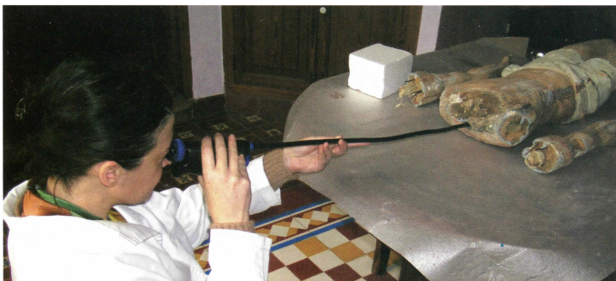
32. Moment de l'observació del buit intern amb el boroscopi, a través d'un orifici existent a la part superior de l'esquena.
