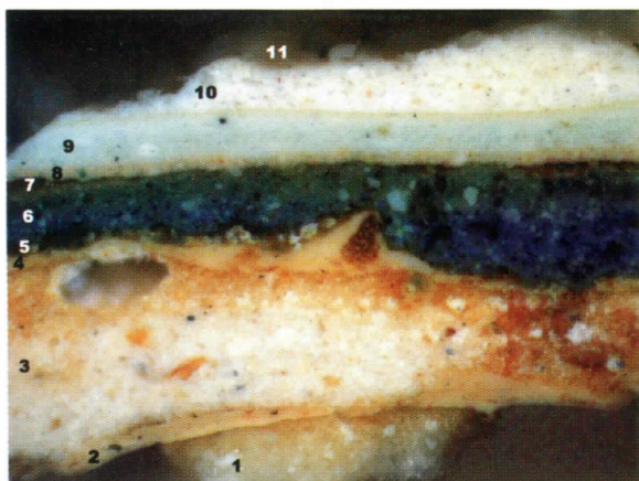
17. Imatge obtinguda al microscopi òptic de la secció transversal de la mostra núm. 3 (objectiu MPlan 20 X / 0,40). L'ordre numèric dels estrats és el que apareix en la taula de descripció annexa.
