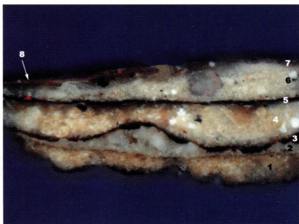
19. Imatge obtinguda al microscopi òptic de la secció transversal de la mostra núm. 4 (objectiu MPlan 20 X / 0,40). L'ordre numèric dels estrats és el que apareix en la taula de descripció annexa.
